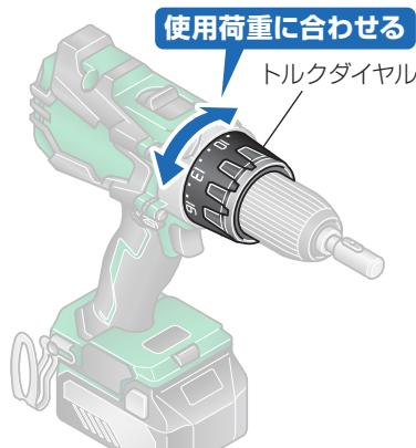
※トルク値は、P.7 注意事項に記載してあるように、事前に使用する充電ドライバーに合わせたトルク値を算出し、最大荷重 2.0kN 以内でご使用ください。
