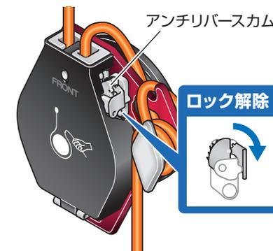
※ロープの伸びの分、正転方向(時計回り)の力が働いており、ハンドル自体が回転しようとするため注意してください。
