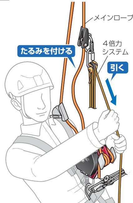
※本製品に掛かっている荷重を4倍力システムへ移します。
