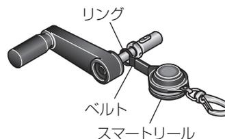
※スマートリールに付属のコネクタは使用せず、スマートリールのベルトを直にリングへ取り付けてください。
